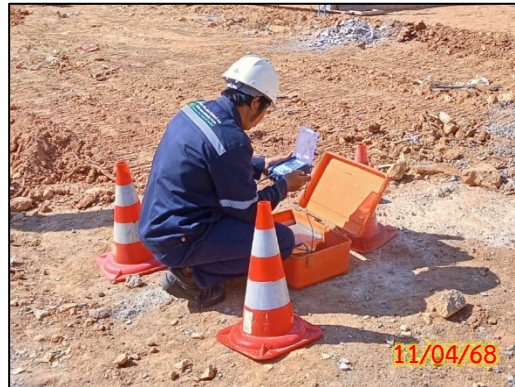
รูปที่ 3.2-4 จุดตรวจวัดความสั่นสะเทือนบริเวณพื้นที่โครงการ ประจำเดือนเมษายน 2568
